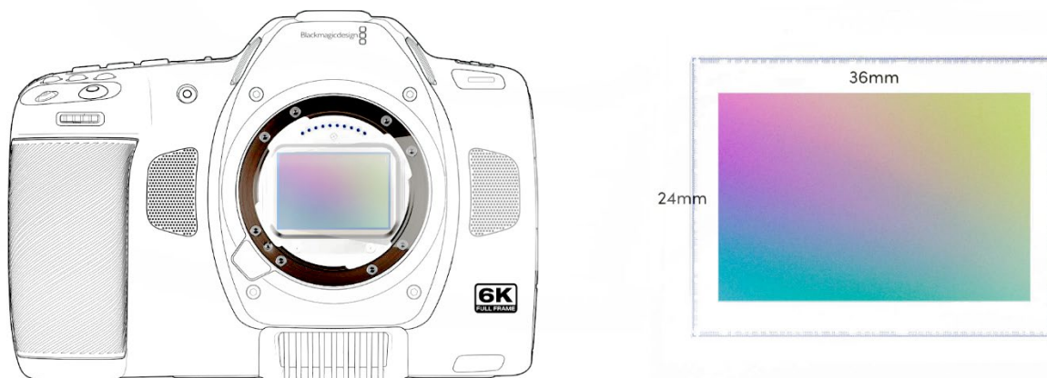
Powyżej – pełnoklatkowy sensor w Cinema Camera 6K.
